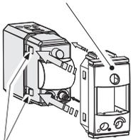
dentini laterali per il fissaggio del frontalino
